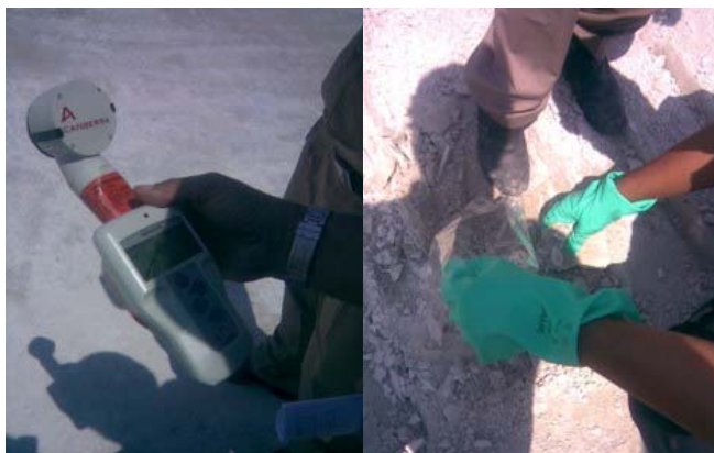
Gambar 5.17. Pengukuran paparan radiasi dan pengambilan sampel lingkungan
