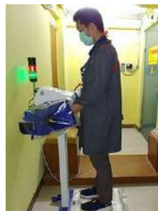
GAMBAR 4. Pemantauan kontaminasi tangan dan kaki dengan Berthold LB 148 hand and foot contamination monitor.
