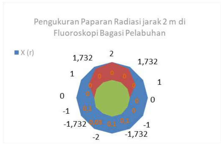
GAMBAR 4. Kurva Isodosis pada pengukuran Paparan Radiasi Jarak 2 m fluoroskopi bagasi di Pelabuhan
