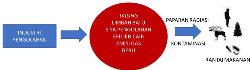
GAMBAR 2. Alur konseptual potensi bahaya dari radiasi pengion dari industri pengolahan tanah jarang yang dapat menjangkau rantai makanan di lingkungan hidup dan masyarakat.
