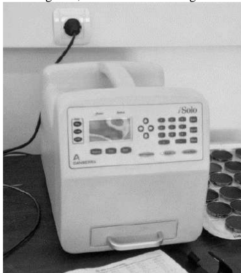
GAMBAR 1. Pencacah beta total (iSolo) dengan detektor PIPS
